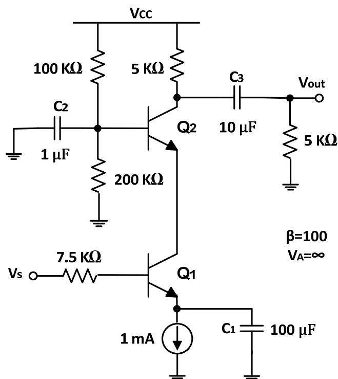
۴- در مدار شکل زیر، قطب ناشی از خازن C1 را بدست آورید.
